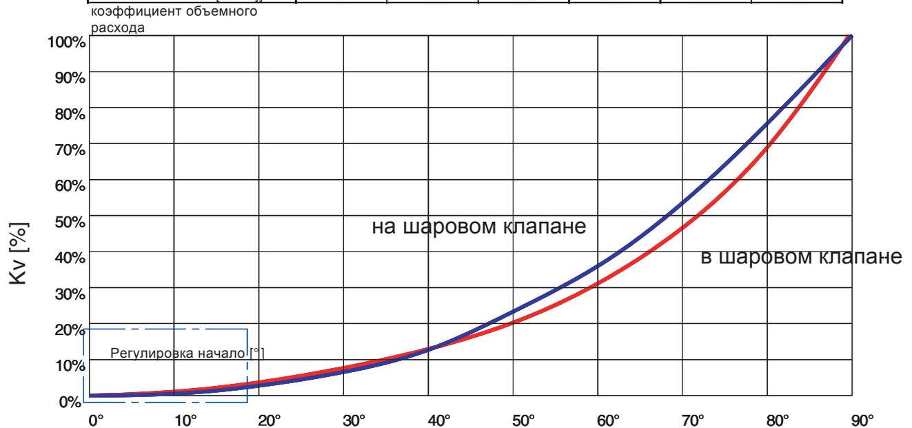
На современных заводах технология контроля – это первейшая необходимость для технологически-ориентированной продукции. Это основная причина широкого использования систем контроля и регулирующих клапанов за большую плату. **BOWLSWITCH®** – это экономичная альтернатива для регулировки без дорогих и хрупких контролеров. Специальный С-образный шаровой клапан **BOWLSWITCH®** обладает прекрасными регулируемыми качествами.
