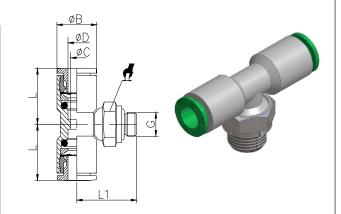
Артикул Т21 Фитинг-тройник цанговый поворотный, тип "L" Технополимер; Серия "Теспо-RAP" ( пустотелый болт из никелированной латуни )
