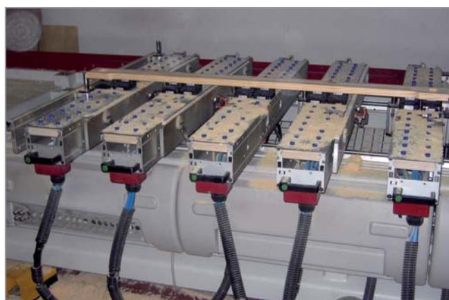
**Innospann Steel-Plate** | Модернизация консольного стола с использованием Steel-Plate, Mono-Base и различных блочных присосок
