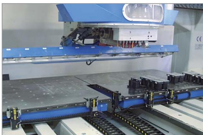
**Innospann Steel-Plate-T** | Модернизация гладкого стола с использованием Steel-Plate-T, Quad-Base и различных блочных присосок
