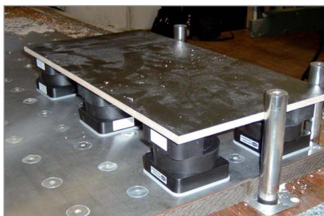
**Innospann Steel-Plate-T** | Модернизация гладкого стола с использованием Steel-Plate-T, Mono-Base и присосок, фиксация на промежуточной плите
