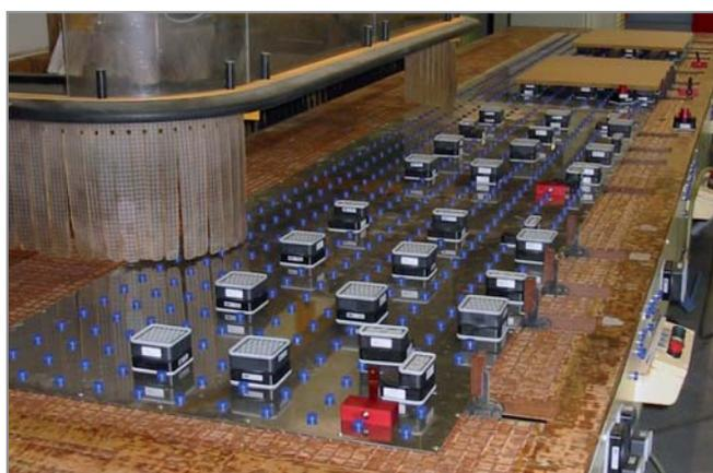
**Innospann Steel-Plate** | Модернизация матричного стола с использованием Steel-Plate, Mono-Base и различных блочных присосок
