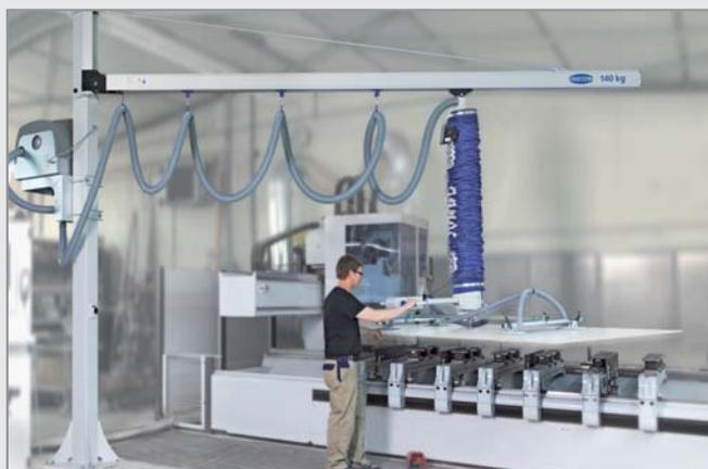
Комплексная система загрузки состоящая из вакуумного шлангового подъемника Jumbo и консольного крана
