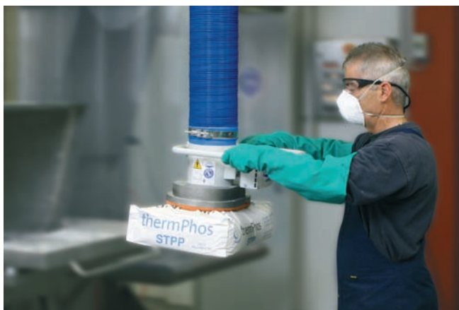
JumboSprint, максимальная грузоподъемность 45 кг., с захватом для мешков, для перемещения пластиковых и бумажных мешков
