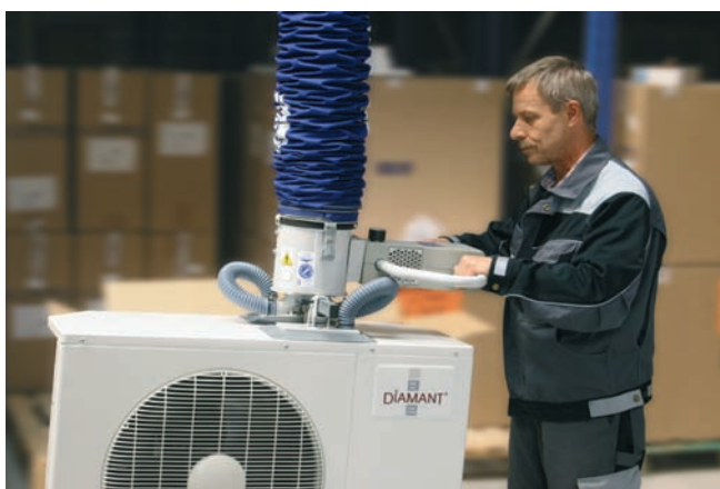
JumboErgo, максимальная грузоподъемность 85 кг., с двойным захватом для переноса кондиционеров
