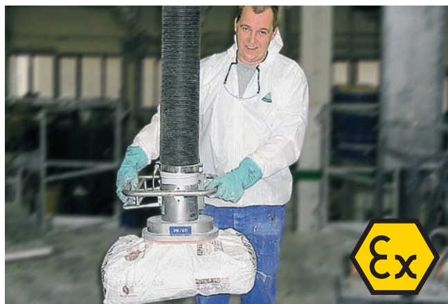
JumboSprint, максимальная грузоподъемность 65 кг., с захватом для мешков, для переноса мешков в зонах, считающихся взрывоопасными согласно классификации ATEX
