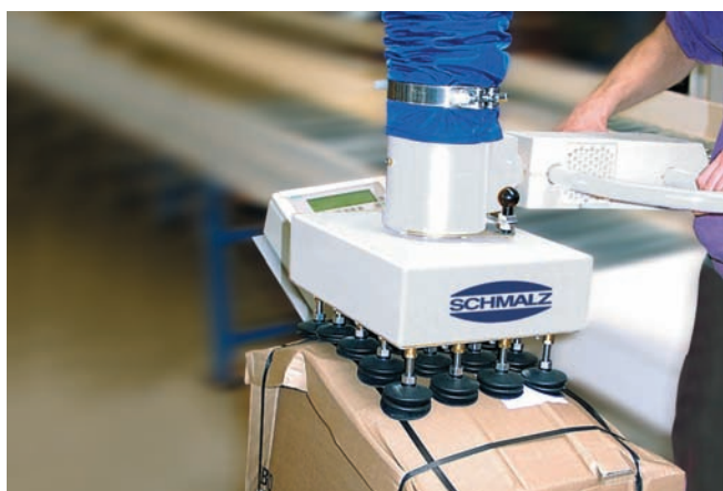
JumboErgo, максимальная грузоподъемность 45 кг., с мульти захватом Comrast для коробок из мягкого картона
