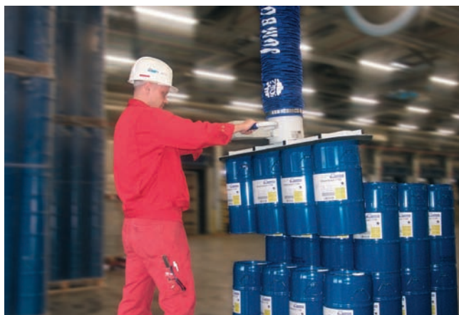
JumboErgo, максимальная грузоподъемность 140 кг., для одновременного подъема четырех бочек
