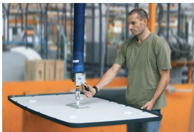
JumboErgo, максимальная грузоподъемность 30 кг., с одинарным захватом для переноса походных столов
