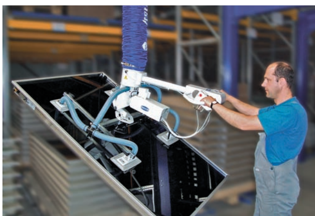
JumboErgo, максимальная грузоподъемность 85 кг., с пневматическим поворотным устройством для подъема солнечных батарей в горизонтальном положении и установки их в вертикальном положении на транспортную тележку
