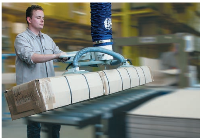
JumboErgo, максимальная грузоподъемность 85 кг., с двойным захватом для картонных коробок длиной до 4 м.
