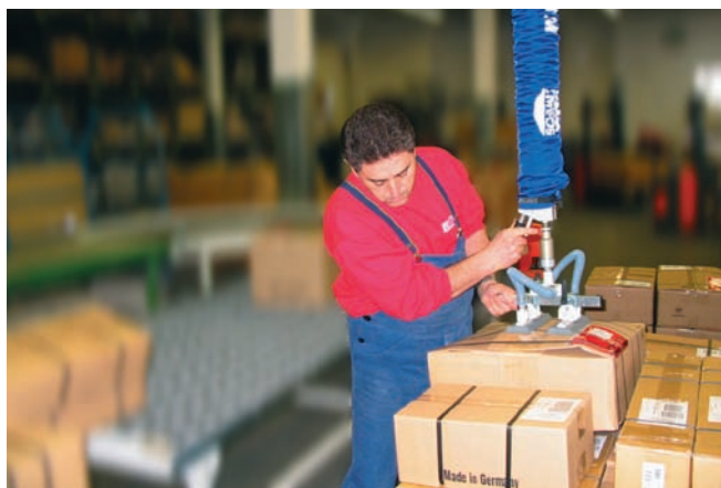
JumboHandy, максимальная грузоподъемность 30 кг., с двойным захватом для картонных коробок
