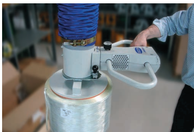
JumboErgo, максимальная грузоподъемность 65 кг., с круглым захватом для переноса рулонов полимерной пленки.
