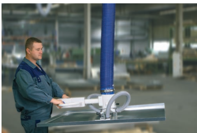
JumboErgo, максимальная грузоподъемность 45 кг., с двойным захватом для загрузки клеильной машины
