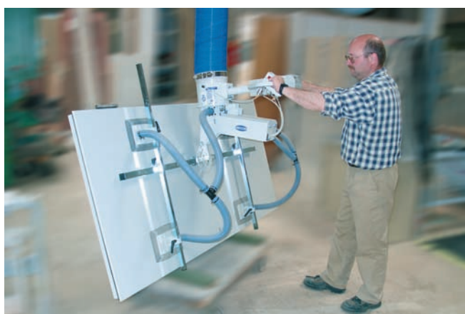
JumboErgo, максимальная грузоподъемность 90 кг., с пневматическим поворотным устройством и четверным захватом для переноса деревянных панелей
