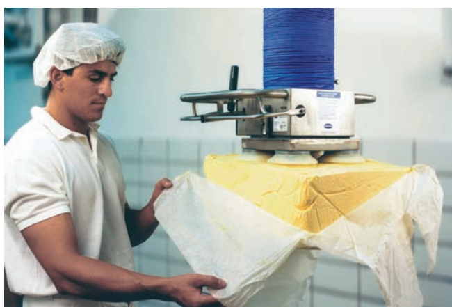
JumboSprint, максимальная грузоподъемность 65 кг., из нержавеющей стали, для переноса продуктов питания на предприятиях пищевой промышленности
