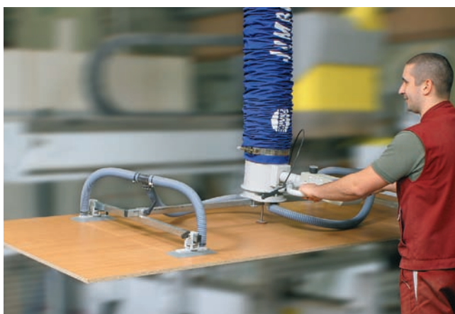
JumboErgo, максимальная грузоподъемность 85 кг., с четверным вакуумным захватом для загрузки и разгрузки деревообрабатывающего центра с ЧПУ
