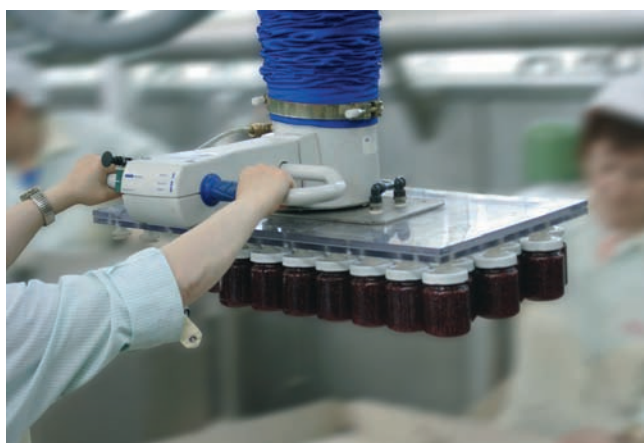
JumboErgo, максимальная грузоподъемность 85 кг., для одновременного переноса 48 банок с джемом
