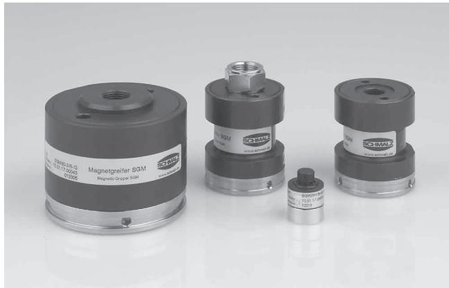
Управление магнитными захватами осуществляется посредством вакуума и/или сжатого воздуха. Магнитное поле создается постоянным магнитом. Они используются, в первую очередь, для манипулирования стальными листами с отверстиями и прорезями, которыми нельзя манипулировать с помощью обычных вакуумных присосок.
