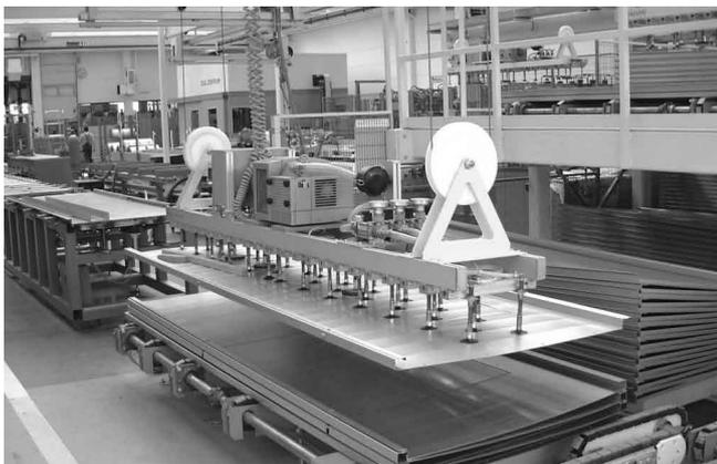
Электромагнитные клапаны EMV для регулирования вакуума в секциях поперечины
