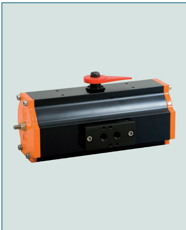
Серия приводов двойного действия состоит из 9 типоразмеров, сконструированных по принципу двойной кулисы
