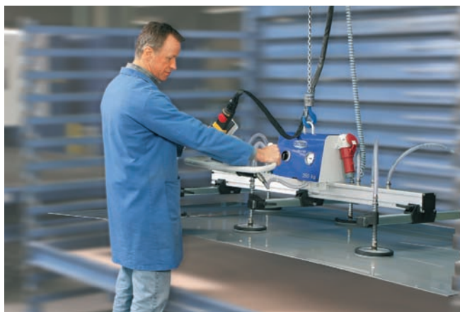
VacuMaster Basic, максимальная грузоподъемность 250 кг., для горизонтального перемещения при загрузке и разгрузке листов металла в стеллажи
