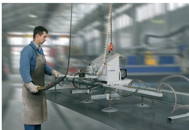
VacuMaster Vario, максимальная грузоподъемность 1000 кг., для горизонтального перемещения при загрузке и разгрузке станков для плазменной резки
