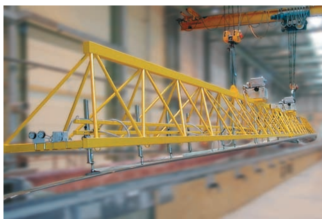
VacuMaster Roto, максимальная грузоподъемность 1500 кг., для манипулирования половинками лопастей ротора.
