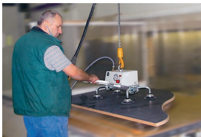
VacuMaster Light, максимальная грузоподъемность 100 кг., для горизонтального перемещения для загрузки станков
