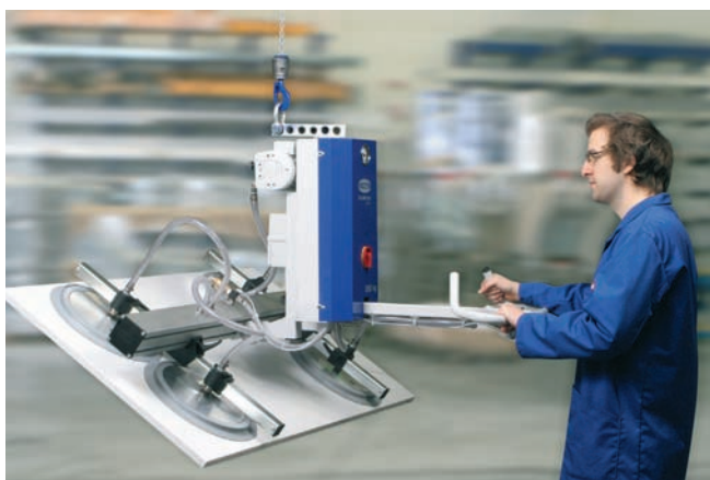
VacuMaster Basic, максимальная грузоподъемность 250 кг., с поворотом на 90°, для манипулирования листами пластика.
