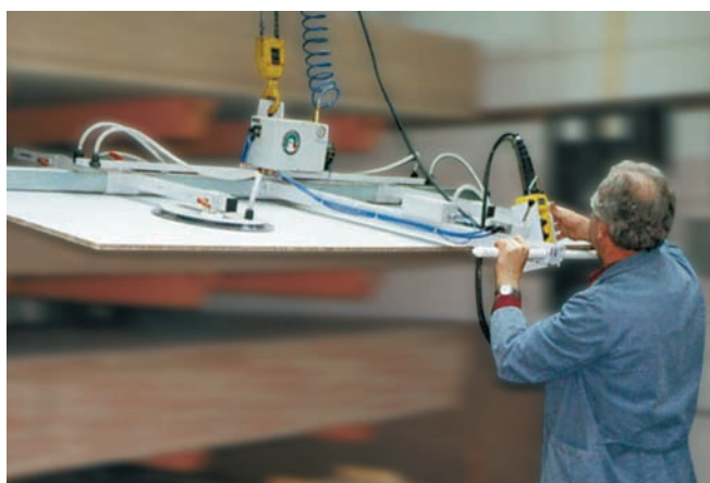
VacuMaster Box, максимальная нагрузка 250 кг., горизонтальное перемещение для выгрузки листов дерева со стеллажей и загрузки их в деревообрабатывающие центры с ЧПУ
