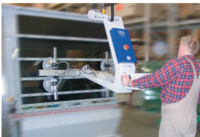
VacuMaster Comfort, максимальная нагрузка 125 кг., с разворотом на 180°, для перемещения листового стекла.
