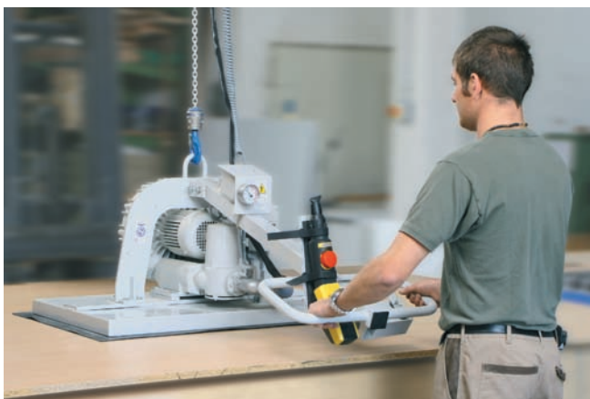
VacuMaster, максимальная грузоподъемность 400 кг., для горизонтального перемещения при загрузке ленточного пильного станка деревянными плитами большого размера
