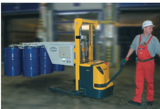
VacuMaster, максимальная грузоподъемность 140 кг., для перемещения бочек от места выгрузки до конвейера.
