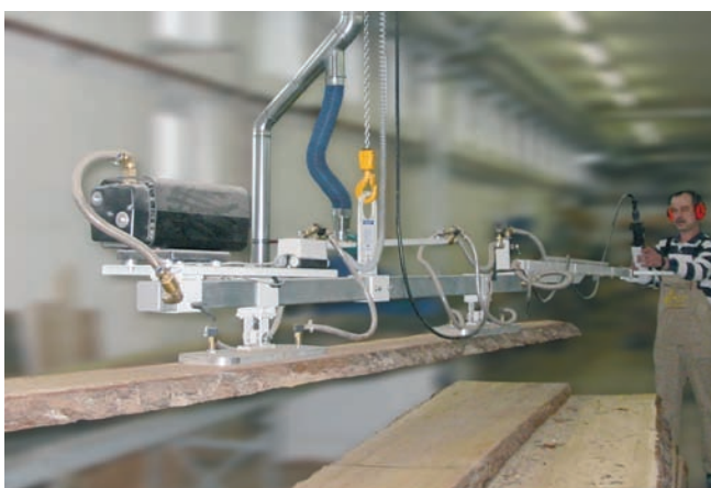
VacuMaster VHB, максимальный вес 500 кг., для переноса досок
