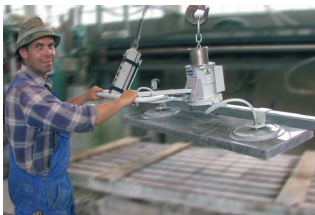
VacuMaster Eco, максимальная грузоподъемность 250 кг., для горизонтального перемещения при загрузке и разгрузке станков для обработки камня
