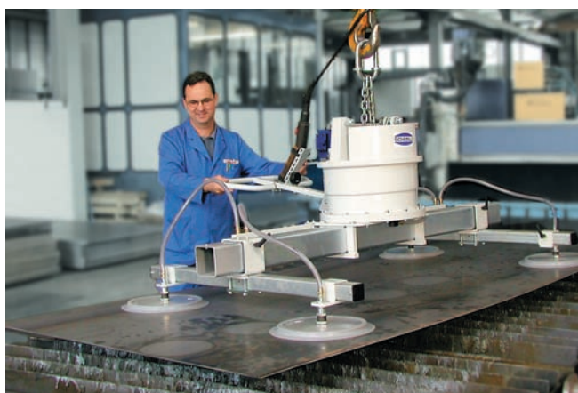
VacuMaster Eco, максимальная грузоподъемность 1000 кг., для горизонтального перемещения при загрузке и разгрузке станков для лазерной резки
