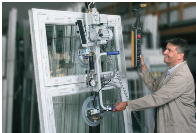
VacuMaster Window, максимальный вес 300 кг., для вертикального перемещения стеклопакетов.
