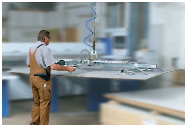
VacuMaster RE, максимальная грузоподъемность 250 кг., для загрузки станков
