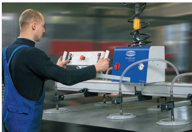
VacuMaster Comfort, максимальная грузоподъемность 750 кг., для горизонтального перемещения листов металла
