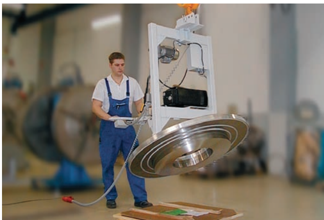
VacuMaster Coil, максимальная грузоподъемность 750 кг., с поворотом на 90°, для манипулирования рулонами и кольцами металлической ленты
