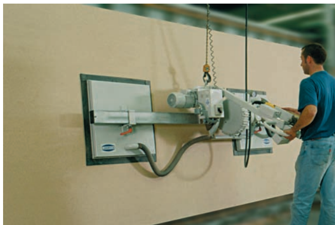
VacuMaster Multi, максимальная грузоподъемность 300 кг., для вертикального перемещения при загрузке вертикального ленточнопильного станка.
