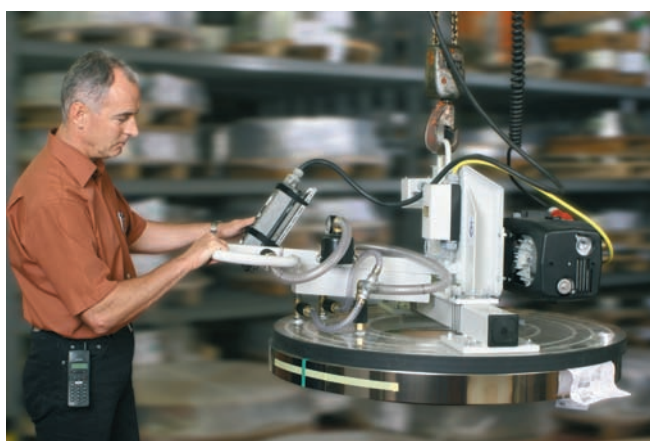
VacuMaster Coil, максимальная грузоподъемность 750 кг., для горизонтального перемещения рулонов нержавеющей стали
