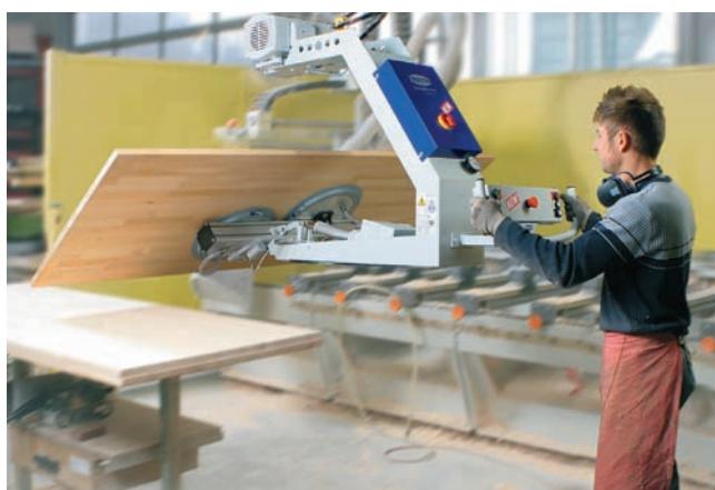
VacuMaster Comfort, максимальная грузоподъемность 125 кг., с разворотом на 180°, для загрузки станков с ЧПУ панелями из клееной древесины
