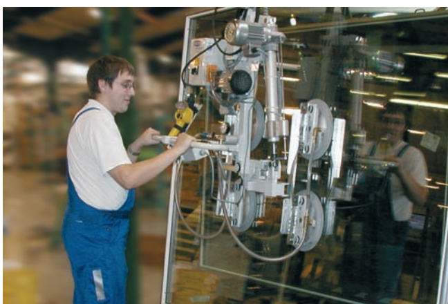
VacuMaster Window, максимальная грузоподъемность 300 кг., для поворота листового стекла и окон в сборе
