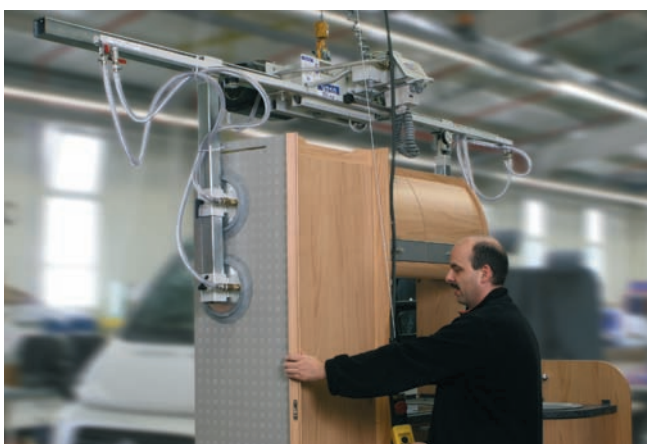
VacuMaster Box, максимальная нагрузка 200 кг, для установки кухонных элементов в трейлерах
