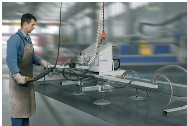
VacuMaster Vario, максимальная грузоподъемность 1000 кг., для горизонтального перемещения при загрузке и разгрузке станков для плазменной резки
