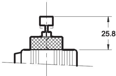
Кнопка ручного управления СМ для типа NC (винтовое исполнение)
