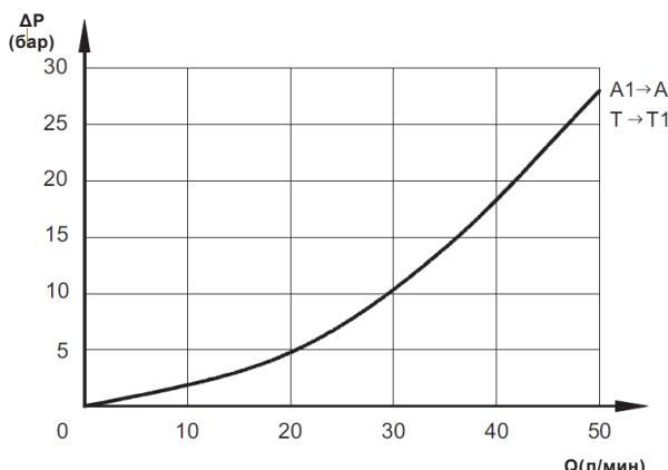
Значения на графике соответствуют высокой скорости потока, проходящего через электромагнитный клапан, и одинаковы как для нормально открытого клапана (исполнение A), так и для нормально закрытого клапана (исполнение C).
