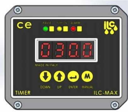
Если в течении 2-х минут не производить настройки, то таймер перейдет в режим сохранения энергии и выключит дисплей.
